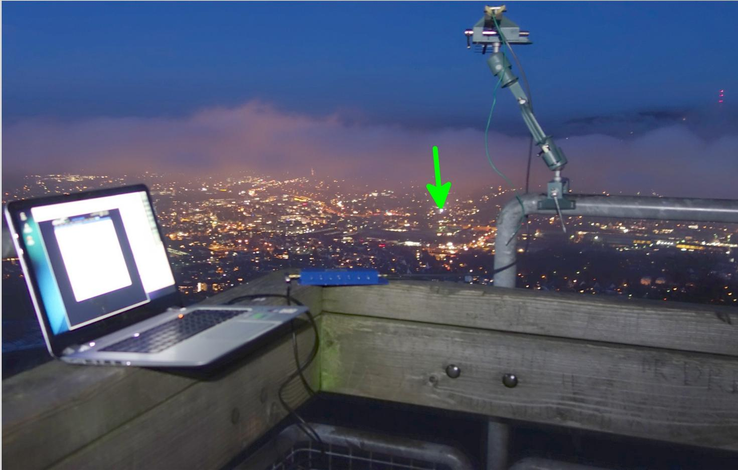
WLAN-Messung mit 2,5 km statt 0,7 m Distanz, zwei 1000 s RTT-Mittelwerte: Theoretisch zusätzliche 16,7  $\mu$ s, Messwert 36,8  $\mu$ s
